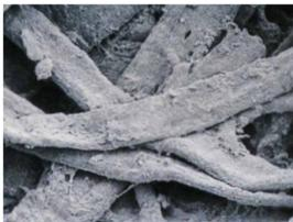
酸化チタンの和紙の付着したTIマッピング写真 (走査型電子顕微鏡写真) 300倍
