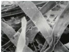
光触媒酸化チタンの和紙の写真 (走査型電子顕微鏡写真) 300倍
